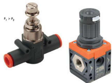
Da mesma forma, também é possível usar os reguladores de pressão da Série Syntesi que, sendo nativamente feitos na versão de descarga rápida, podem ser inseridos entre a válvula e o cilindro, executando a mesma função que a dos redutores Line On Line em caso de necessidade de taxas de vazão mais elevadas.
