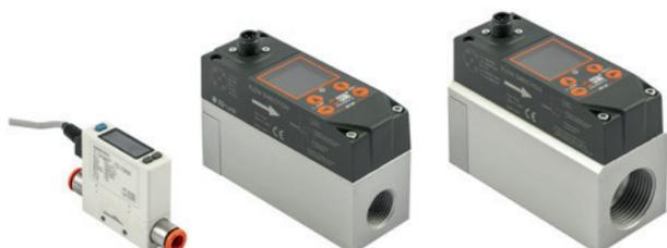
Do ponto de vista de comunicação, uma saída digital PNP - configurável sobre o valor da taxa de vazão, pressão ou consumo total - e uma saída analógica que pode ser ajustada em tensão (0-10 VCC) ou corrente (4-20 mA) estão disponíveis. Versões com interface IO-Link com características similares também estão disponíveis. Portanto, FLUX 1 e 2 também podem ser utilizados como medidor de vazão, chave de fluxo, manômetro e pressostato.
