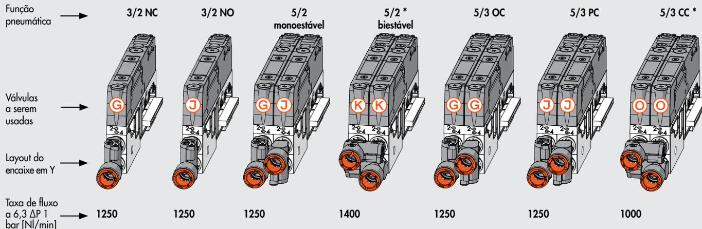
Para obter um fluxo de 5/2 monoestável, 5/2 biestável e 5/3 DC fluxo alto, use duas válvulas paralelas, ao energizar os solenoides simultaneamente.
