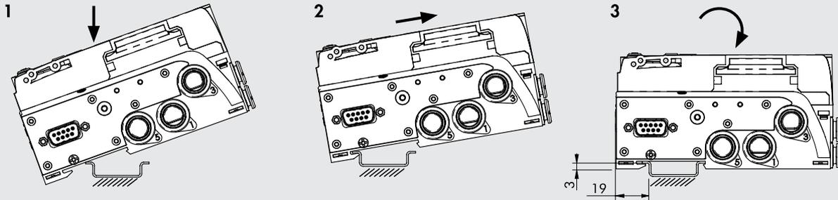
Fixação por meio de suportes: os 3 suportes já estão inclusos em cada pacote EB 80 BOXI. Empurre-as firmemente no interior das sedes apropriadas na base até ouvir o "clique".
