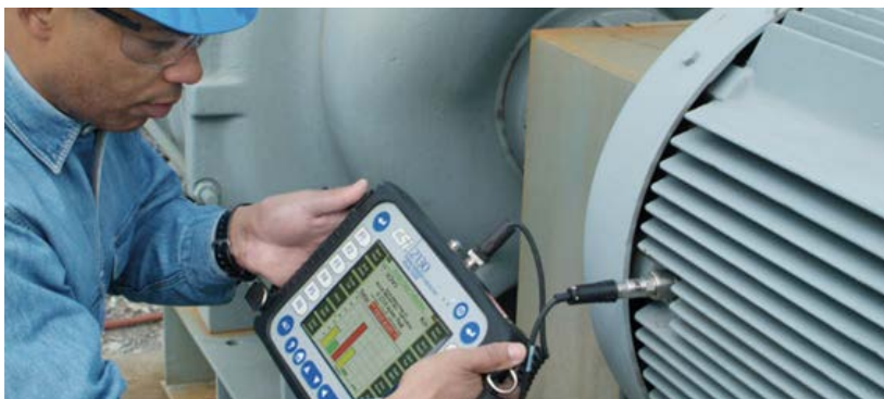
Figura 3 - Coleta de dados para manutenção preditiva
