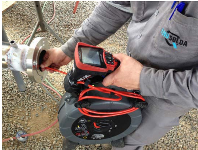
Figura 1 - Endoscopia em equipamentos industriais
