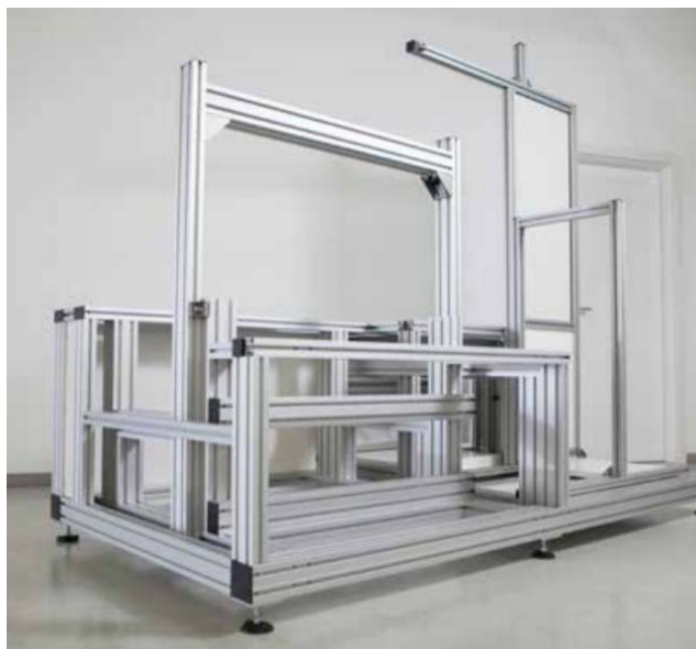
Figura 61 - Estrutura de máquina em perfil de alumínio
